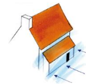
Création de bâtiments annexes du côté du vent
