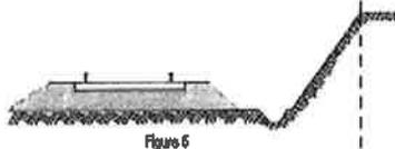
Dans le cas d'une voie posée à flanc de coteau, la limite légale à considérer est constituée par le point extrême des déblais ou remblais effectués pour la construction de la ligne et non la limite du terrain naturel (figures 6 et 7).
