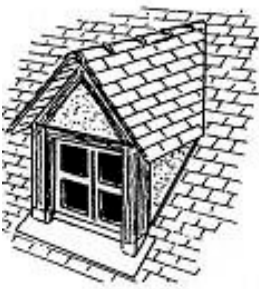
Lucarne en bâtière
