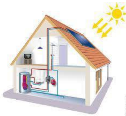
Figure 13: Schéma de principe de fonctionnement des capteurs solaires thermiques (source : ADEME)
