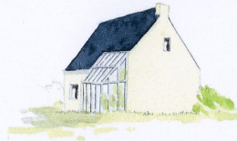
Le volume de la véranda est inséré dans celui de la maison. Continuité de la pente du toit.
