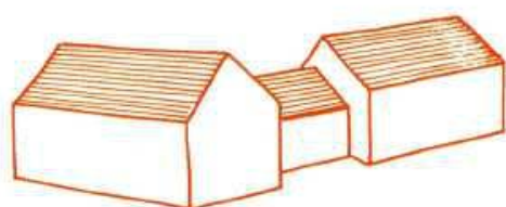
Corps de bâtiments en équerre
