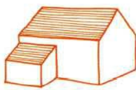
Extension en appentis
