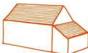
Extension en appentis
