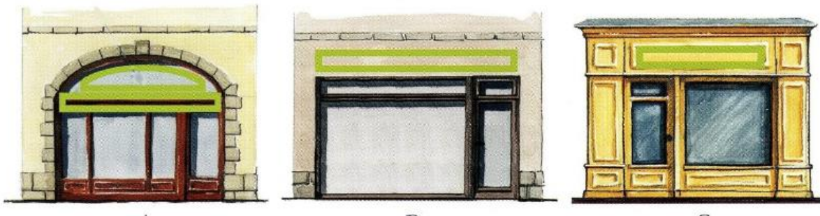
Positionnement des enseignes en bandeau – source : UDAP77
