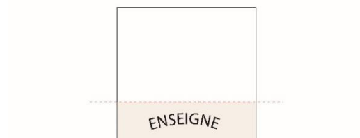
Adhésif en lettres découpées sur fond translucide, installée dans les 30% de la vitrine à partir du sol.
