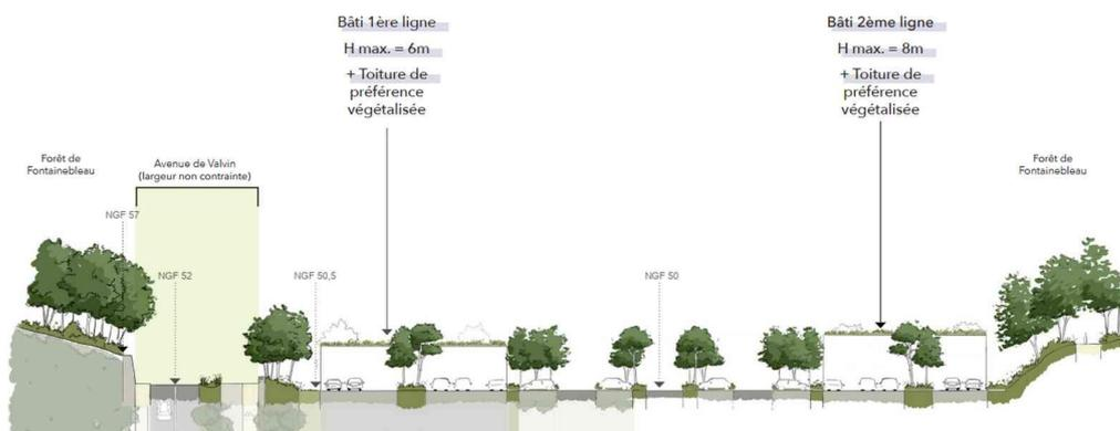
Figure 6: Coupe en travers - Source Notice p.37
