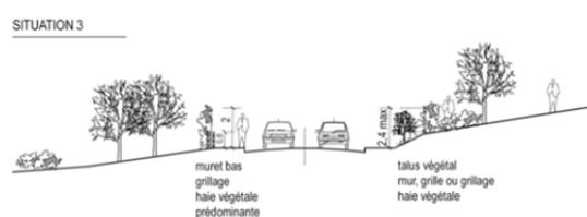
Principe d'implantation des clôtures sur un terrain en pente.
