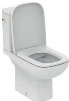
Pack WC sur pied sans bride RimLS+® Okyris. Cuvette à sortie horizontale en porcelaine vitrifiée, carénée, avec kit de fixation caché et fourni. Abattant thermotur standard recouvrant, fixation par le dessus. Réservoir à alimentation latérale, pré-percé à gauche et réversible par permutation du mécanisme. Mécanisme de chasse préinstallé en 3/6 L avec remplissage en différé. Dimensions 35,5 X 66 cm. Poids : 46,4 kg.
