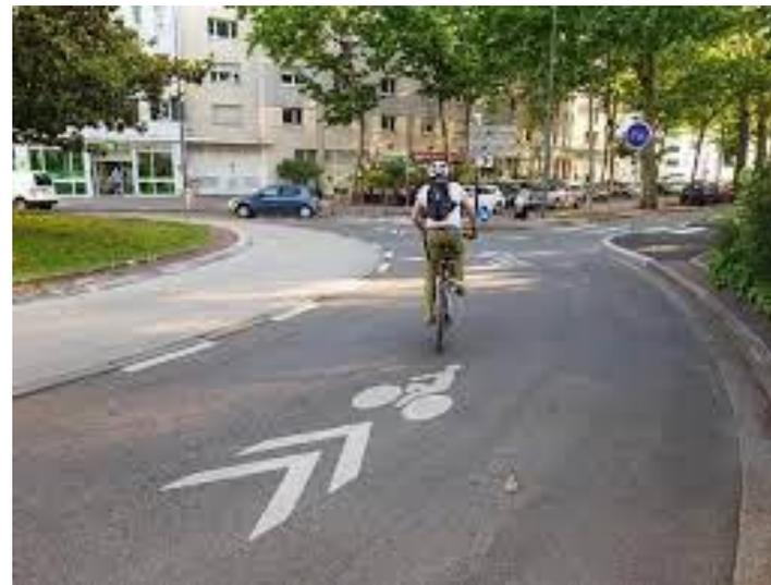
Exemple de disposition d'un jalonnement horizontal pour signaler la présence de vélos dans le giratoire.
